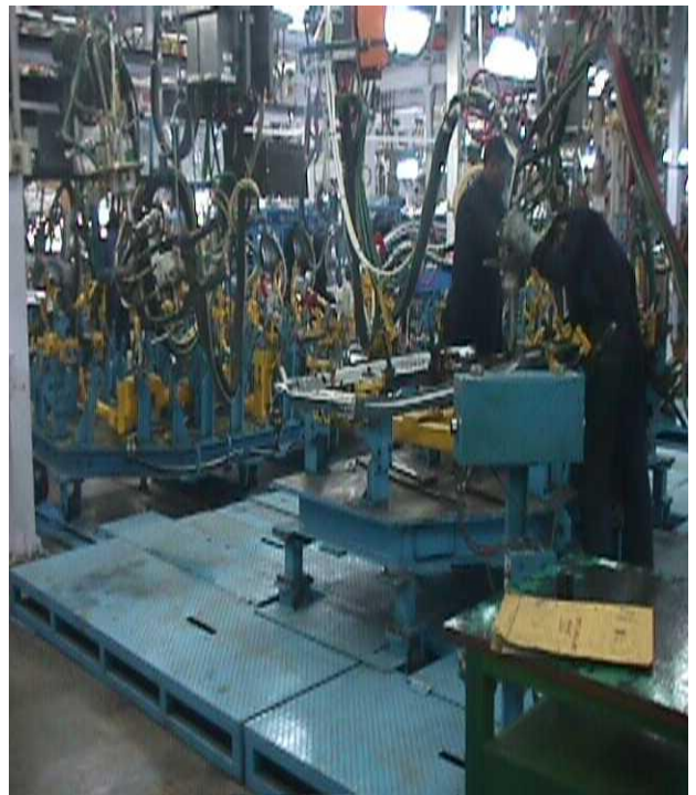
LH door welding
